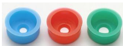
V09 Uszczelki regulujące przepływ niebieska – 7,2-12 L/min. czerwona – 12-15 L/min. zielona – 15-20 L/min.
